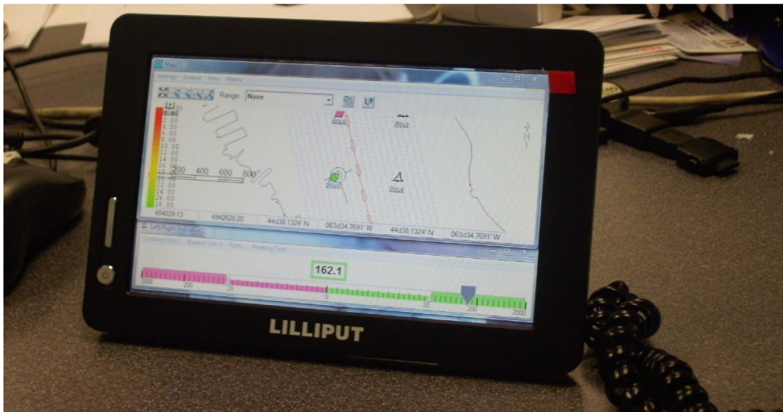
РИСУНОК 2. Монитор, настроенный с окном Карты СЪЕМКИ НУРАСК® и индикатором уклонения от галсов
